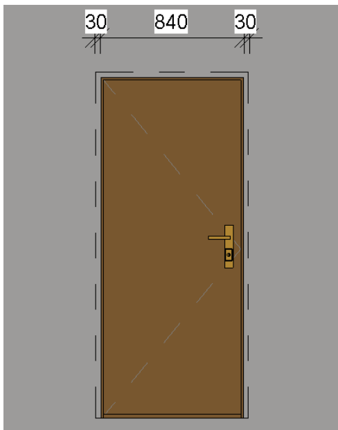
Obr. Přesah stěny přes hranu zárubně při pohledu z exteriéru
